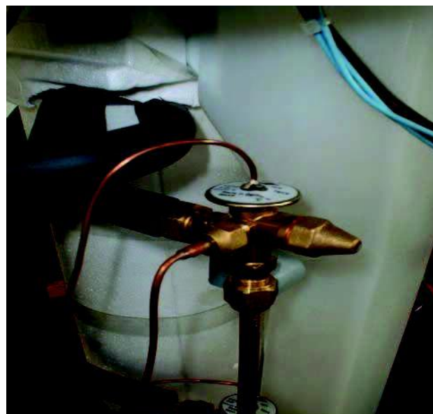
5 Valvola di regolazione della pressione di evaporazione costante (Danfoss KVP 12 nel MF 58 e Danfoss KVP 22 nel MF 68)
